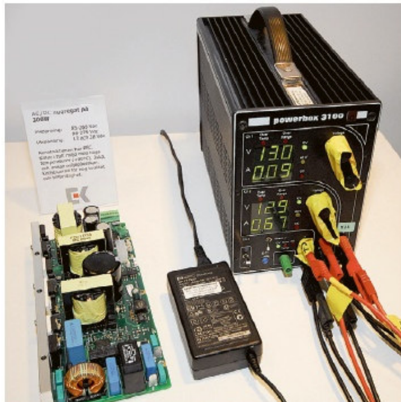
För de tre typerna av kraftaggregat gäller olika regler: Aggregatet till vänster omfattas inte av direktivet eftersom dess effekt överstiger 250 W. Laddaren för konsumentprodukter i mitten omfattas av direktivet vilket dock labbaggregatet till höger inte gör, eftersom det är avsett för industriell miljö.
